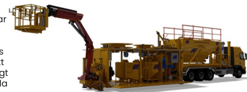
Figur 1: Modern insprutningsrigg och lastbil ihopmonterad för lagring av fogmassa. Med tillstånd av AMV Norge.
